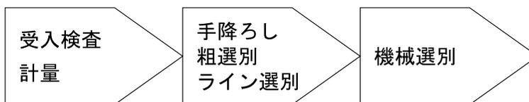
搬入時に受入検査、計量を行った廃棄物を、手降ろしヤード、粗選別、ライン選別、機械選別の工程を経て、廃石膏ボード、がれき類（コンクリート等）、金属くず、紙くず、廃プラスチック類、木くず、可燃物等の品目別廃棄物に適切に分別しております。これらの廃棄物をさらに異物・付着物の除去、素材別選別、切断、破碎、圧縮等の再資源化機械処理を行うことで精選別し、品質・ロットを整えた上で、可能な限り再資源化品として搬出してあります。その再資源化品の内容は、石膏ボード原料、再生砕石、再生砂、鉄、非鉄、製紙原料、再生用プラスチック等のマテリアルリサイクル用資源、木チップによる**バイオマス発電**(\*8)、プラスチック、紙等からなるエネルギー化用可燃物による廃棄物発電といったエネルギー化用資源であります。
